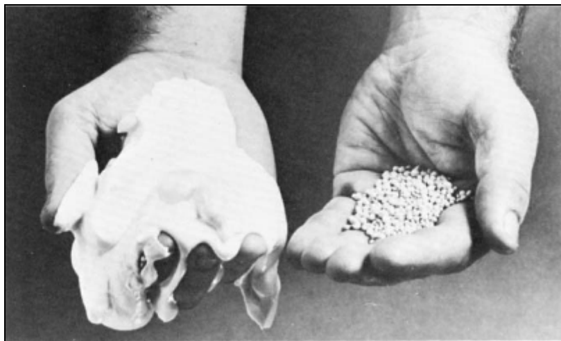
شکل ۳: سمت چپ دانه های خروجی از راکتور سختی گیری دانه ای و سمت راست لجن متداول سختی گیری است
